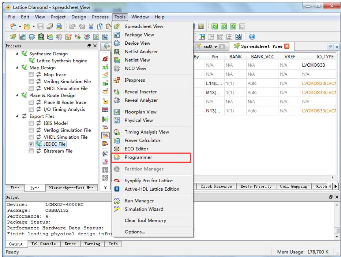
3、在进入 FPGA 编程前，IDE 会检测调试工具，如下图。调试工具正确安装驱动后，会自动识别，因此选择默认即可。
