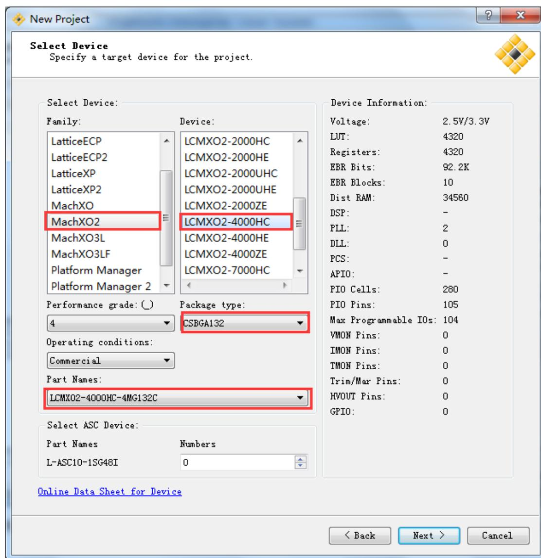
6、综合工具选择，可以选择第三方综合工具，但本人一般使用原厂综合工具，故默认设置。直接 Next。
