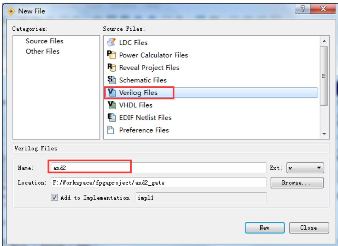
3、在新创建的 Verilog 文件中进行 Verilog HDL 代码编写。编写完成后，保存。IDE 自动将模块更新到左侧 Hierarchy(层次)窗口。
