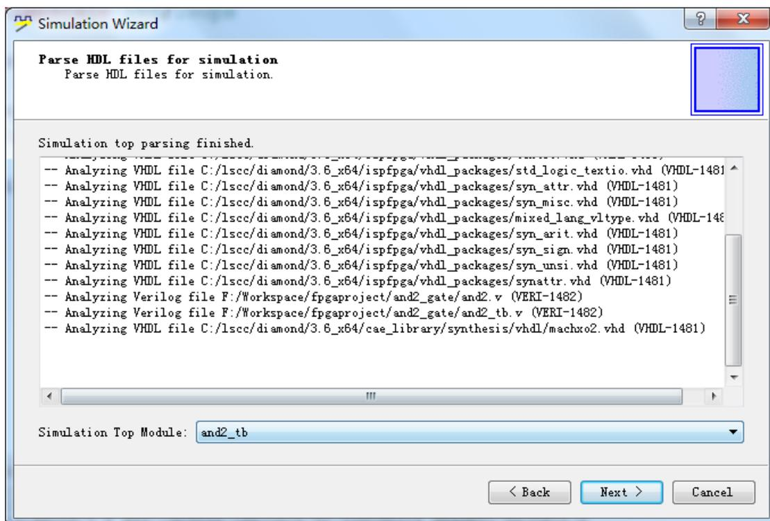
10、仿真工程项目创建完成，如果下方选项确定，将会在完成后自动执行仿真并显示波形文件。
